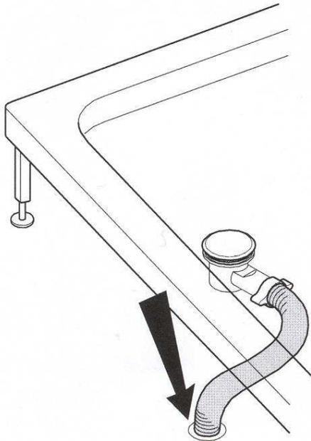
**11** Sluit de afvoerslang aan op de afvoer. (slang in optie)
