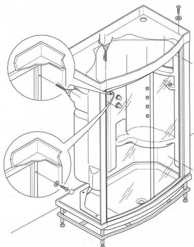
**10** Controleer de positie van de deur ten opzichte van de douchebak en dak. Bevestig de douchedeur in de compensatieprofielen met 2 + 2 schroeven 0,39 x 16,4 en pvc afdekkopjes. Maak 6 verbindingen tussen het dak en het bovenste douchedeurprofiel met 6 schroefjes van 0,36 x 16. Regel de wieltjes van de schuifdeur door de excentrieken af te stellen.
