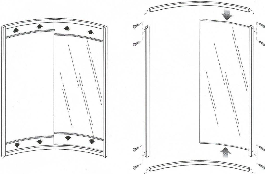
**5** Monteer het glasraam door dat onderste en bovenste profiel aan elkaar te schroeven met de 4+4M4 x 30 schroeven. Zet de dichtingen in rubber en pvc in de openingen van de profielen.
