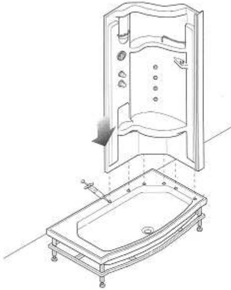
**3** Haal de rechter kolom uit de verpakking. Spuit silicone op de rand waar de kolom geplaatst word; evenwel vóór de bevestigingsschroeven.(zie tekening). Bevestig de kolom met de bijgeleverde zelfborende schroeven.
