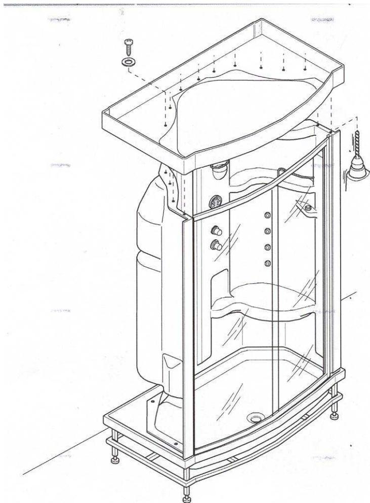
**9** Neem het dakelement uit de verpakking en leg dit op de cabine. Centreren en bevestiging met de zelfborende schroeven.
