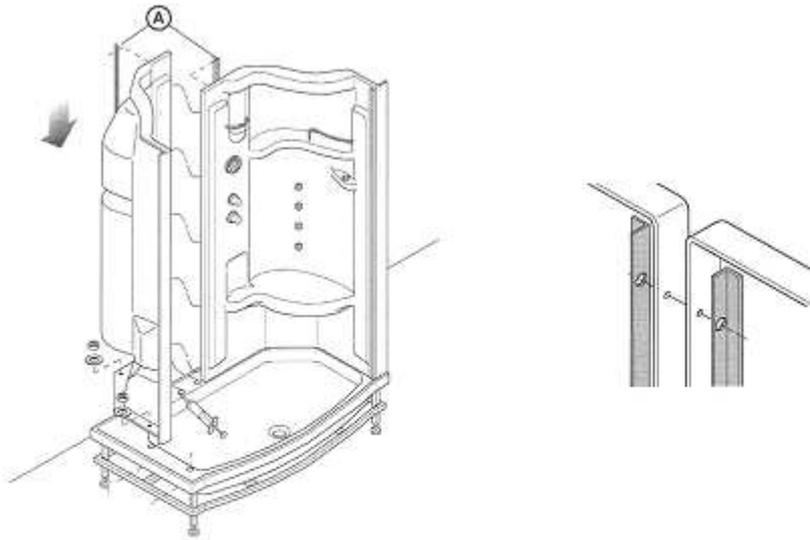
**4** Haal de linkse wand uit de verpakking en spuit silicone op de plaats waar deze op de douchebak komt (let op! vóór de bevestigingsschroeven (zie tekening)). Bevestig beide wanden aan mekaar met de bijgeleverde boorschroeven ( in optie verstevigingprofielen (zie tekening)).
