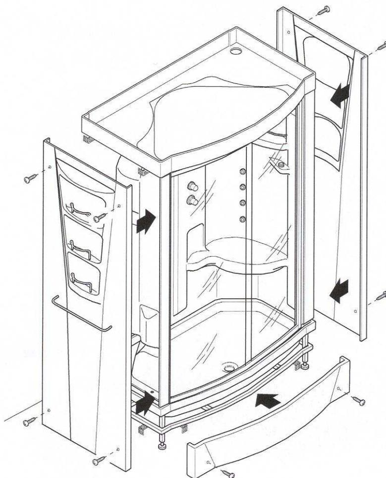
**14** Positioneer de cabine in de hoek en ga na of alles naar behoren functioneert. Om de cabine stevig vast te zetten volstaat het in de opstaande zijrand van het dak langs iedere kant een gaatje te boren en in de muur te bevestigen met schroeven.
