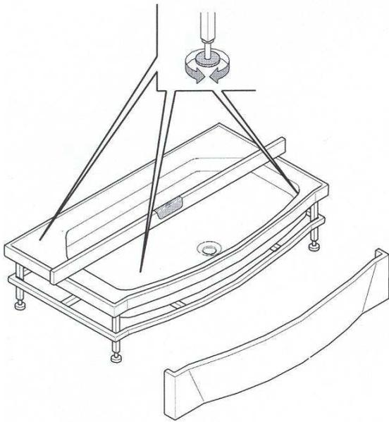
**1** Haal de douchebak uit zijn verpakking. Plaats deze waar hij moet staan en zet waterpas door de stelvoeten in of uit te draaien. Controleer ook de uitlijning ten opzichte van de muur.
