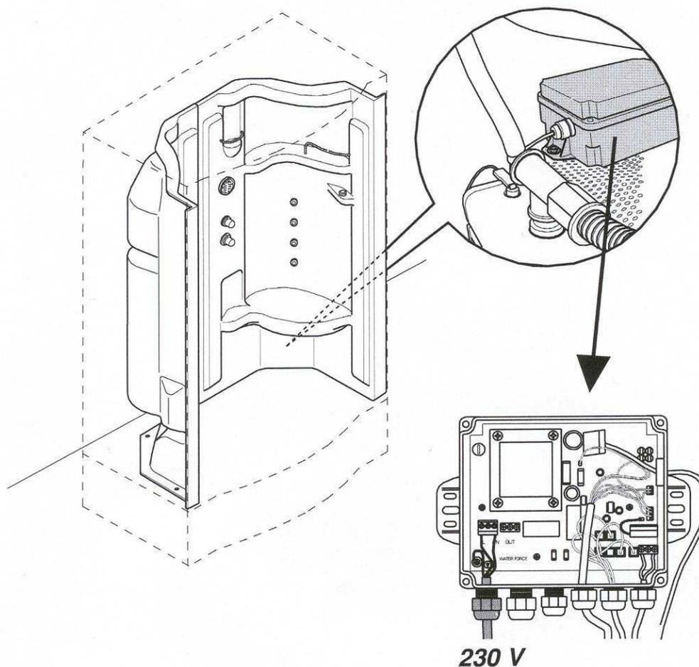
**13** Aansluiting van voedingskabel 230V. Elektronische doos loskoppelen en deksel afnemen.
