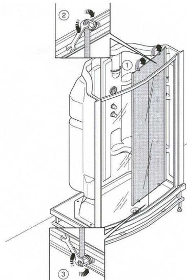
**8** Zet de twee bovenste wieltjes van de schuifdeur in het bovenste profiel door aan de excentrische moer met een sleutel van 17 mm te draaien kan men de hoogte van de deur regelen. Zet nu ook de twee onderste wieltjes in de onderste zuil. Draai deze lichtjes omhoog.
